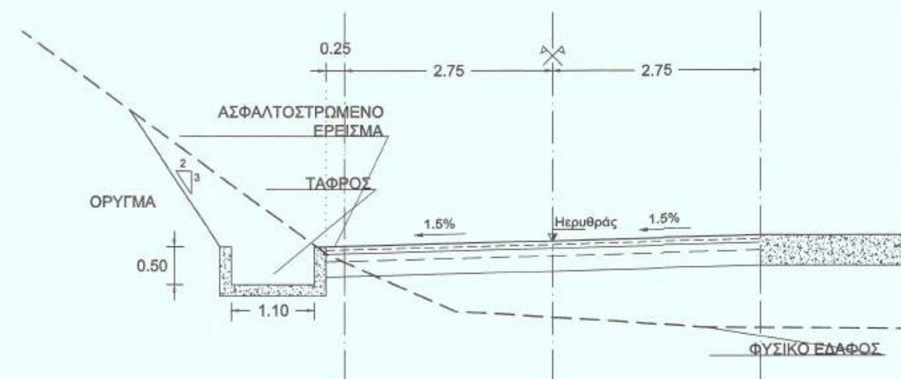
ΔΙΑΤΟΜΗ ΟΔΟΥ ΜΕ ΤΑΦΡΟ ΟΜΒΡΙΩΝ ΟΡΘΟΓΩΝΙΚΗΣ ΔΙΑΤΟΜΗΣ
