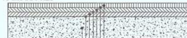
ΔΙΑΜΟΡΦΩΣΗ ΤΩΝ ΔΑΠΕΔΩΝ ΚΥΚΛΟΦΟΡΙΑΣ ΕΔΡΑΖΟΜΕΝΩΝ ΣΕ ΕΠΙΦΑΝΕΙΑ ΑΠΟ ΟΠΛΙΣΜΕΝΟ ΣΚΥΡΟΔΕΜΑ
